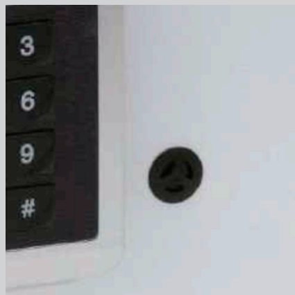
Chave de emergência atrás da tampa magnetizada
